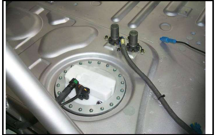
RE4) Réservoir à essence monté (Vue de l'habitacle) Fuel tank mounted (seen from the cockpit)
