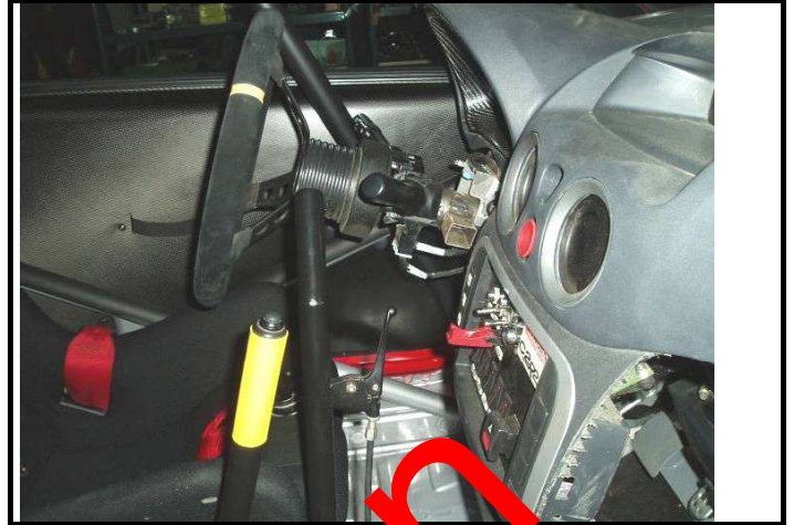
CB2) Commande de boîte de vitesse (montée) Gearbox control (mounted)
